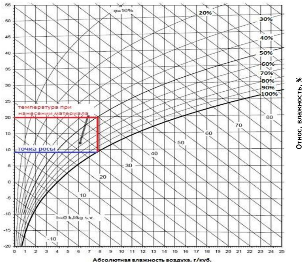
Пример использования диаграммы МольеОпределение точки росы при температуре +20°C и относительной влажности 50%:
